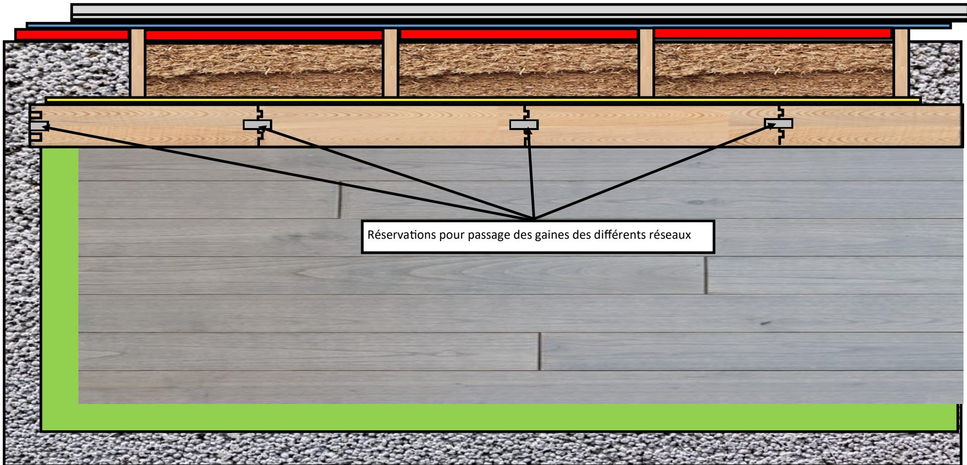
**Vue de dessus principe avec pose vêture (HPL ou autre)**
